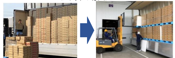
バラ積み・バラ降ろしによる非効率な荷役作業 パレットの利用による荷役時間の短縮
